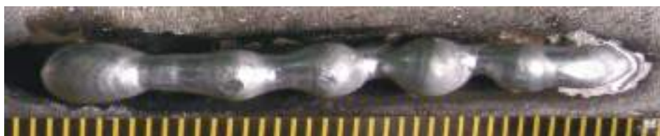
Рис. 3.30. Наплавленный валик: I_d = 25 А; U_d = 15 В; V_{св} = 3,74 м/ч
