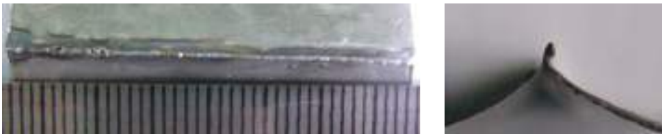
Рис. 4.16. Образцы из стали 1X18H9T: I_d = 3 \text{ A} ; U_d = 28 \text{ B}
