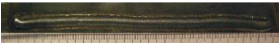
Рис. 3.18. Валик, наплавленный на малоуглеродистую сталь: I_d = 26\text{--}28 А; U_d = 18 В; V_{св} = 6,75 м/ч
