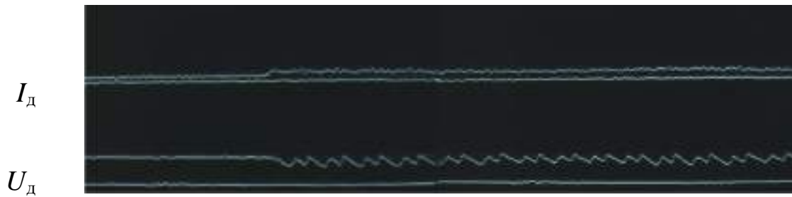
Рис. 3.4. Осциллограммы зажигания и горения дуги: I_d = 2,8 \text{ A} , U_d = 30 \text{ B}
