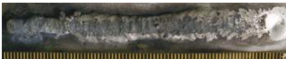
Рис. 3.28. Внешний вид шва при неудовлетворительной защите. I_d = 20 А; U_d = 15 В
