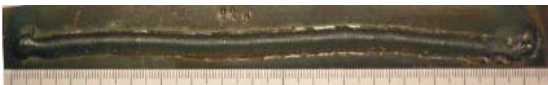
Рис. 3.19. Внешний вид наплавленного валика: I_d = 25 А; U_d = 18,5 В; V_{св} = 6,75 м/ч
