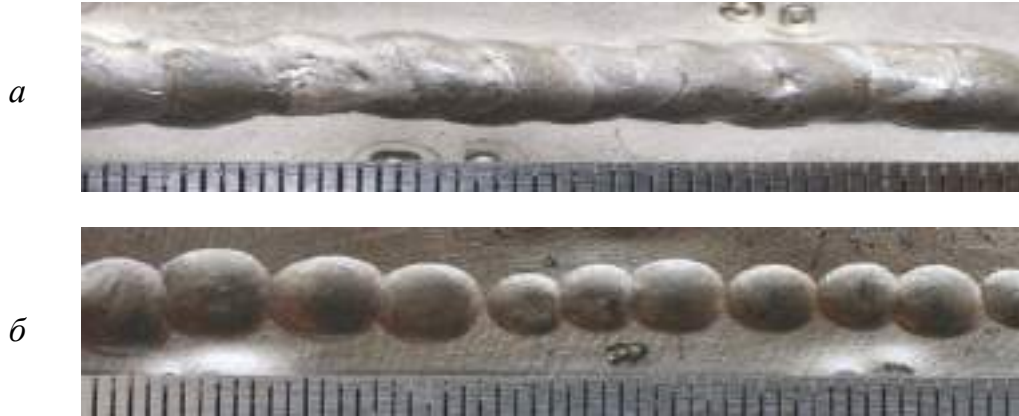
Рис. 3.41. Шов: а – вид сверху; б – обратная сторона
