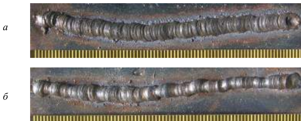
Рис. 3.48. Валики, наплавленные в чистом азоте на малоуглеродистую сталь толщиной 1 мм: a – U_{д} = 22,5 В; б – U_{д} = 17,5 В
