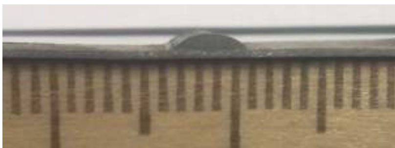
Рис. 3.23. Поперечное сечение наплавленных валиков проволокой диаметром 1,2 мм: I_d = 28 А; U_d = 19 В; V_{св} = 6,75 м/ч
