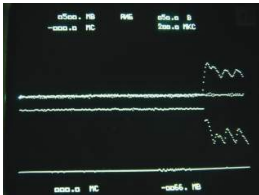
Рис. 2.5. Осциллограмма процесса зажигания дуги электродом МР-3 диаметром 2 мм ( I_d = 10\text{--}12 А; U_d = 24 В)
