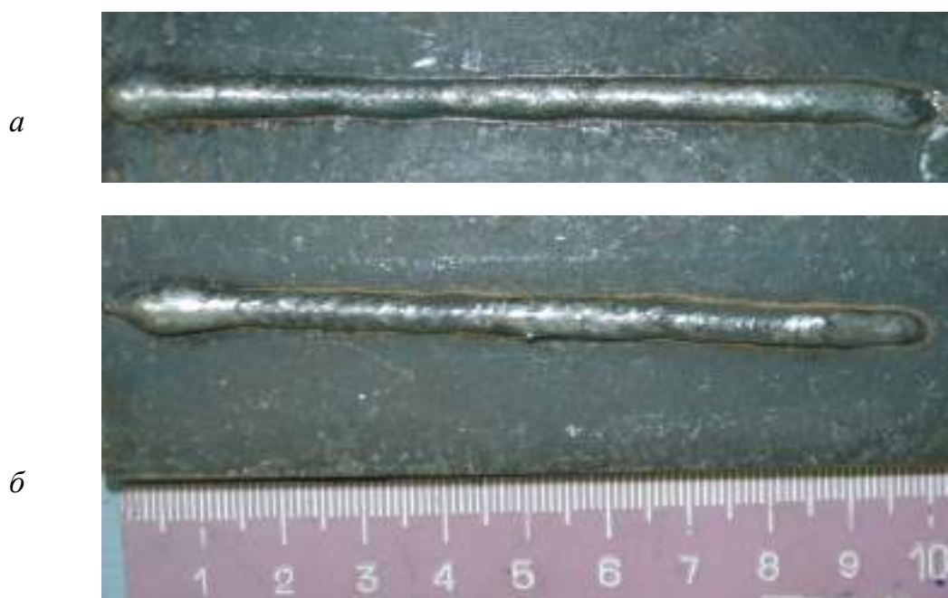
Рис. 3.47. Валики, наплавленные на малоуглеродистую сталь в состоянии поставки без зачистки: а – обратная полярность, б – прямая полярность. Сварочный ток 120 А
