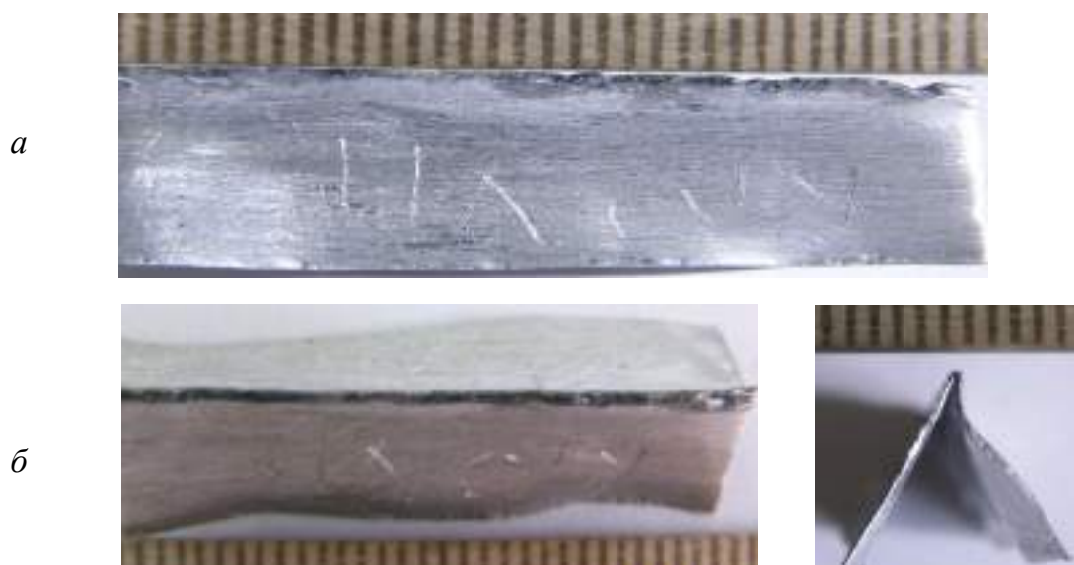
Рис. 4.23. Образец, сваренный по отбортовке: а – вид сверху, б – вид сбоку. I_d = 4,5\text{A} ; U_d = 15\text{ В} , толщина образца 0,2 мм
