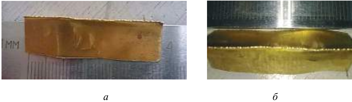
Рис. 4.25. Образец, сваренный по отбортовке: а – вид сверху; б – вид сбоку
