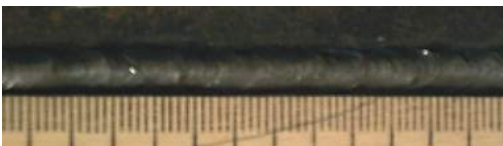
Рис. 3.13. Внешний вид наплавленного валика: I_d = 120 А; U_d = 20 В; V_{св} = 16 м/ч
