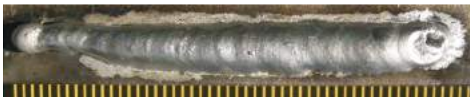
Рис. 3.29. Внешний вид наплавленного валика: I_d = 25 А; U_d = 14 В; V_{св} = 3,7 м/ч
