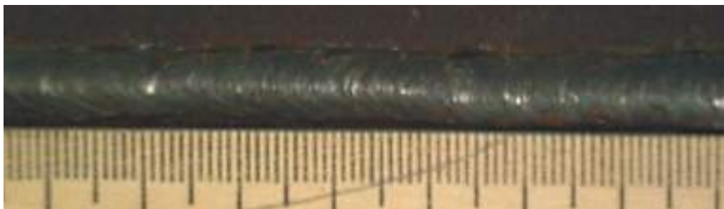
Рис. 3.12. Внешний вид наплавленного валика: I_d = 150 А; U_d = 20 В; V_{св} = 16 м/ч
