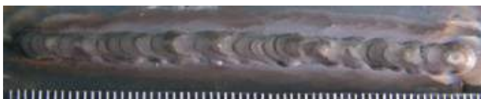
Рис. 3.50. Валик: I_{д} = 40–45 А; U_{д} = 18–19 В
