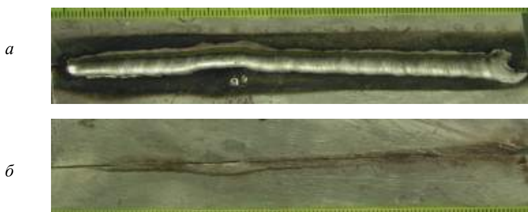
Рис. 3.38. Наплавленный валик (а) и его обратная сторона (б). I_d = 30 А; U_d = 15 В; V_{св} = 6,7 м/ч; вылет 9–10 мм; толщина изделия 1,1 мм
